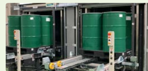
原料自動倉庫から原料が出てくる様子
