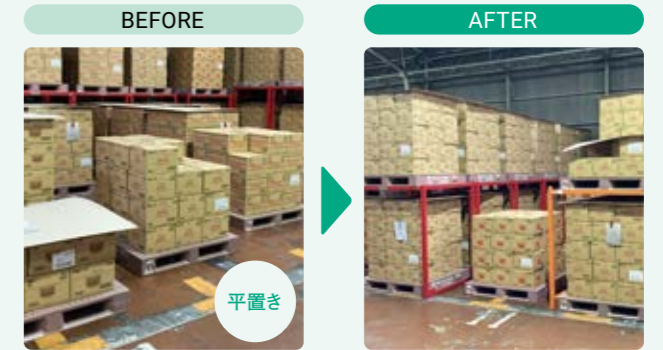
平置きからネステナーを利用することで空間活用成功(上野工場)
