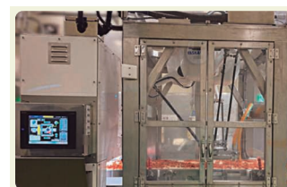
茨城工場に導入された夾雑物除去システム
